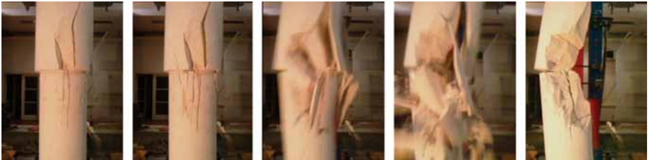
Slika 10. Raspucavanje uzorka K1 (VS) u posljednjoj fazi ispitivanja
